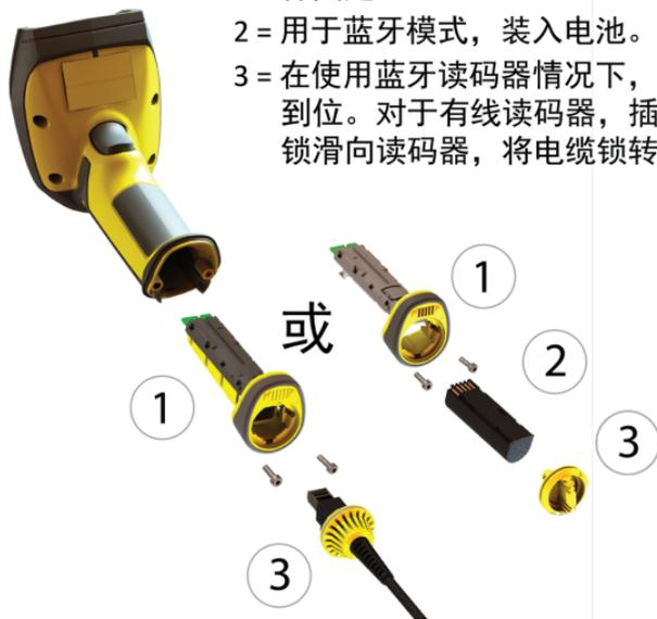
**i** 注意: 插入/取出通信模块之前, 断开 DataMan 8072 的电源连接或取出电池。
