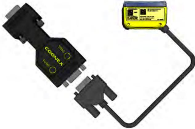
Die DataMan-Steuereinheit ist mit zwei Tasten und einem Summer ausgestattet. Die Tasten sind mit den Eingangsleitungen 0 und 1 des DataMan 50/DataMan 60 verbunden. Der Summer ist mit Ausgangsleitung 0 verbunden.
