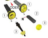
Hinweis: Trennen Sie den DataMan 8050 von der Stromversorgung oder nehmen Sie die Batterie heraus, bevor Sie Module einschieben oder herausnehmen.
