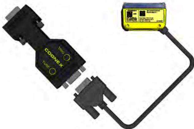
Le boîtier de commande DataMan a deux boutons et un signal sonore. Les boutons sont connectés aux entrées de ligne 0 et 1 sur le DataMan 50 et 60. Le signal sonore est connecté à la ligne de sortie 0.
