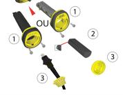
Observação: Desconecte o DataMan 8600 da alimentação ou retire a bateria antes de inserir/remover os módulos de comunicação.
