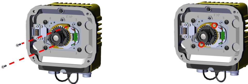
6. Vuelva a colocar el módulo de iluminación y apriete los cuatro tornillos.
