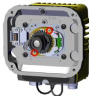
6. Vuelva a colocar el módulo de iluminación y apriete los cuatro tornillos.
