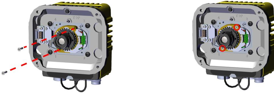
6. Remettez le module d'éclairage en place et serrez les quatre vis.
