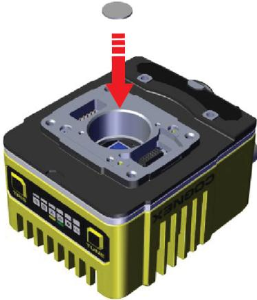
2. Vissez l'optique liquide sur le filtre passe-bande.
