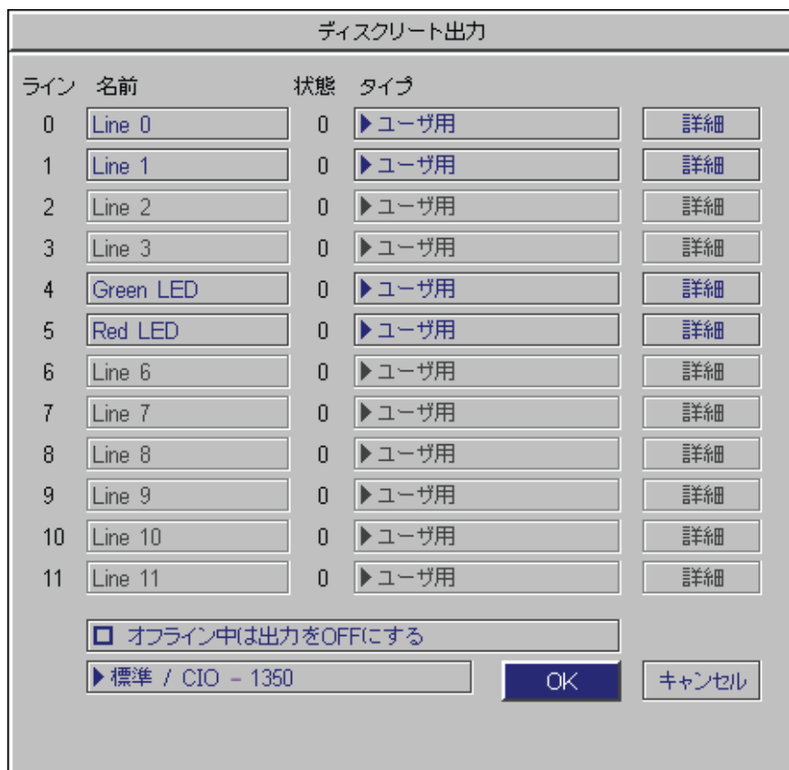
図 B-3: [ディスクリート出力] ダイアログのデフォルト設定
