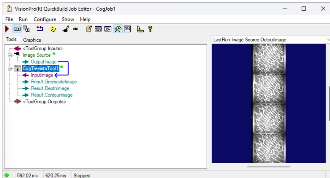
9. 打开 Trevista 工具编辑控件。下图显示查看工具生成的深度图像的编辑控件：
